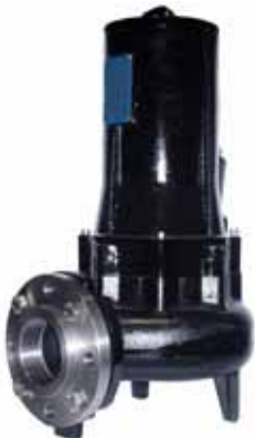
Pompes eaux usées et fécales 0 - 850 m 3 /h — jusqu'à / bis 39 m. Granulométrie / Korngröße: max. 108 mm Abwasser- und Fäkalienpumpen
